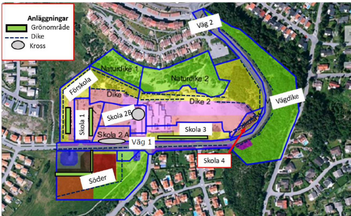
Figur 31, skiss över föreslagen dagvattenhantering från fördjupad dagvattenutredning (AFRY, 2022-11-25)
