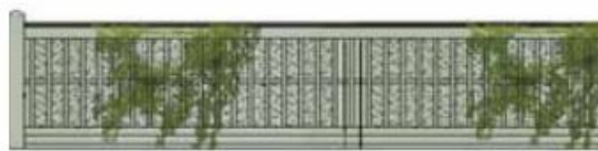
1,5 meter hög bullerskärm på vägens östra sida.
