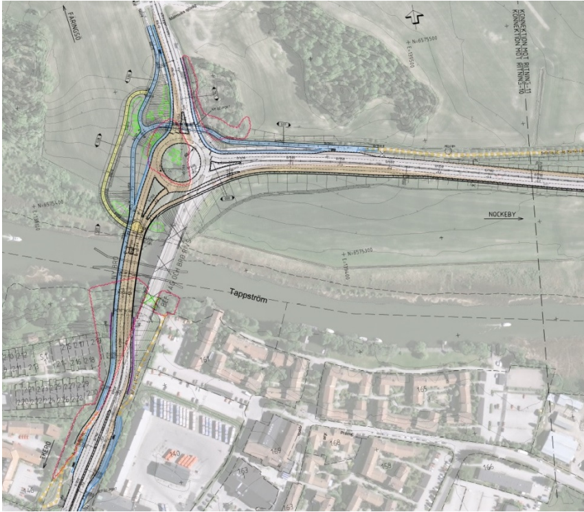
Illustration från vägplanens granskningshandling, placering av ny bro. (Trafikverket, Väg 261)
